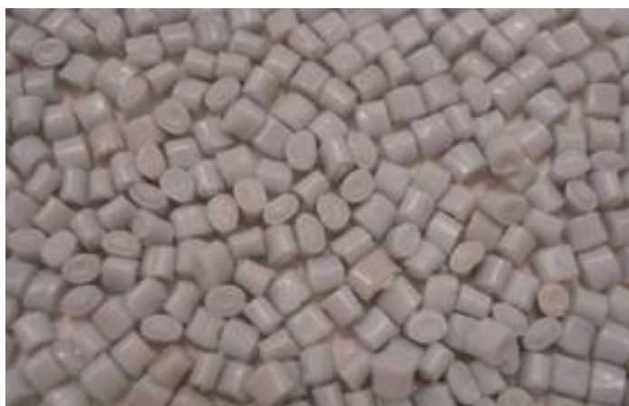
Figura 11: Granza obtenida después procesar los residuos de plástico PET, tiene unas características muy similares al material virgen.
