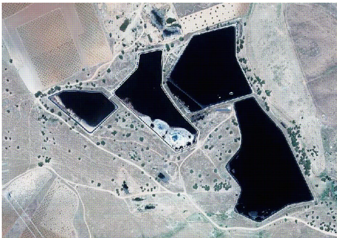
Figura 5: Balsas de evaporación de residuos de lejías, salmueras y aguas del proceso de la industria del aderezo de aceitunas de la Agrupación de Industriales de Aceituna de Almendralejo, S. L. (ADIADA).
